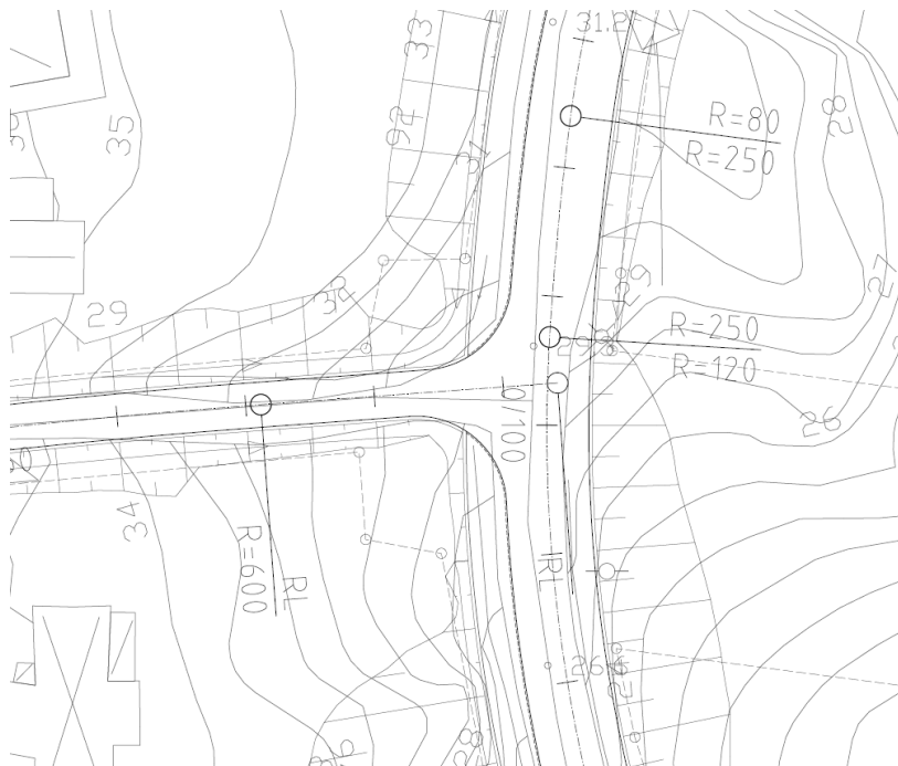
Figur 20. Förslag på utformning av korsningen Breviksvägen-Talgoxevägen, med gång- och cykelbana väster om Breviksvägen.
