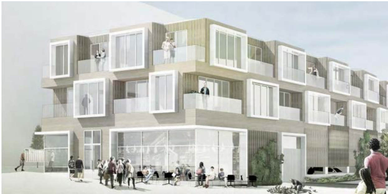
Illustration med förslag på påbyggnad av befintligt p-däck. Infarten till p-däcket behåller sin placering (till höger i bild) men byggs in tillsammans med lokal för verksamhet i bottenvåningen mot torget (Tengbom).
