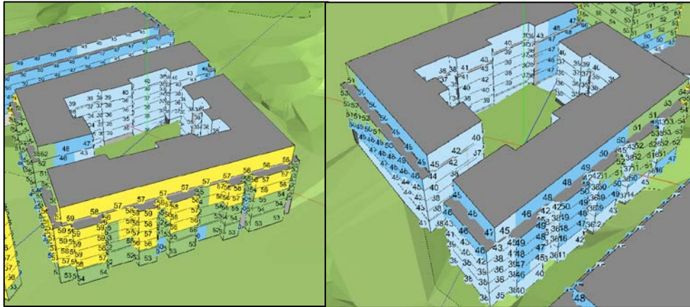
Figur 3. Ekvivalent ljudnivå vid fasad (frifält) för kv. 13. Vänstra bilden visar 3D-vy från nordväst. Högra bilden visar 3D-vy från nordöst.
