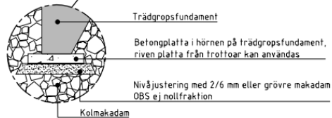
TRÄDGROPSFUNDAMENT, NIVÅJUSTERING PRINCIPDETALJ SKALA 1:10
