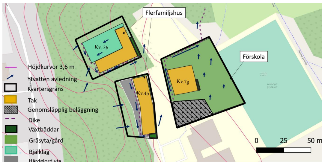
Figur 15. Systemskiss över potentiella dagvattenåtgärder. Magasinsbehovet ( 12 \text{ m}^3 ) uppnås i förslaget med 60 \text{ m}^2 växtbäddar. Som förslag på dagvattenåtgärder inom kvartersmarken är även genomsläpplig beläggning samt diken utritade. Observera att utritade växtbäddar bör placeras i anslutning till stuprör med utkastare för enkel avledning och delas upp i fler än en växtbädd per tak för att kunna omhänderta vatten från hela takytan.
