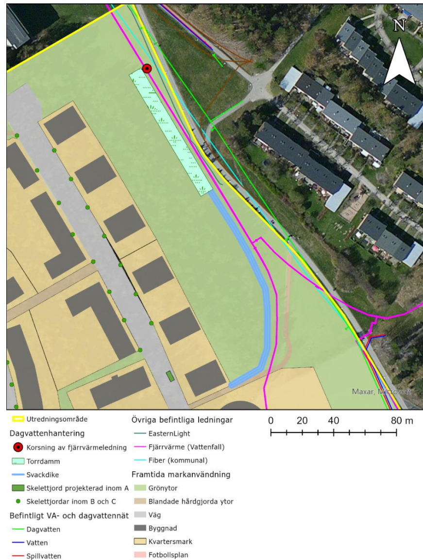
Figur 18. Karta som visar placering och ytbehov av svackdike och torrdamm.
