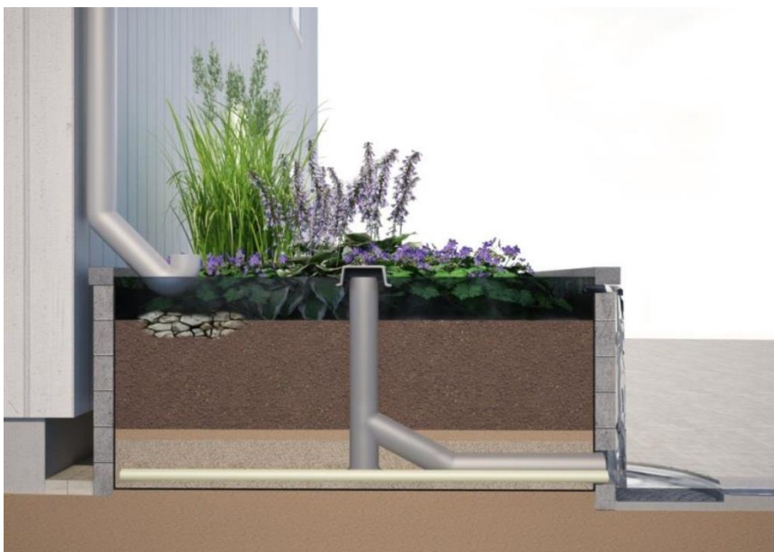
Figur 11 Exempel på en så kallad nedsänkt växtbädd. Nedsänkningen under kanten skapar en utjämningsvolym. I detta fall är anläggningen utförd som en konstruktion som ligger över marknivå. Illustration Kent Fridell och Kristian Klasson, Tengbomgruppen AB.
