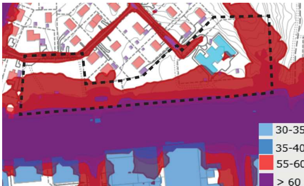
Bullerkarta med planområdet markerat med en svart gräns. Inom planområdet varierar ljudnivåerna mellan 30- 60 dBA.
